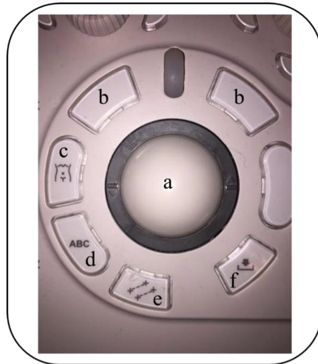
图 7 功能键/符号的布局示例：a.轨迹球，b.未标记的“选择”键，c.体位图，d.注释，e.测量，f.存储。
