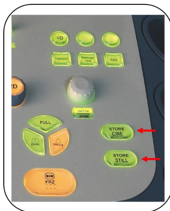
图 8 “图像存储”和“视频存储”按钮示例（箭头）。
