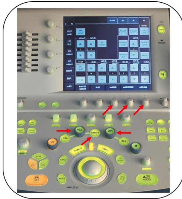
图 12 为方便使用而设计的多普勒功能键的布局（箭头）。
