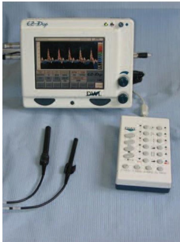
图 1 配备两个探头和频谱分析的连续多普勒设备
